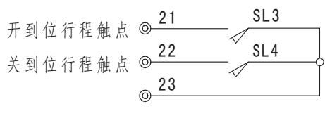
参考控制器接线 —————— 电装内部接线
